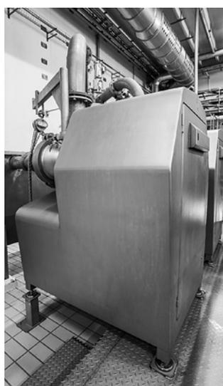
O moedor alimentado por bomba da Haarslev funciona particularmente bem com insumos mais viscosos e mais bombeáveis. A bomba de alimentação conectada garante uma taxa de fluxo consistente que ajuda a eliminar o deslizamento. O fluxo consistente também garante um corte limpo do material que passa pelo moedor e produz as melhores condições possíveis.
