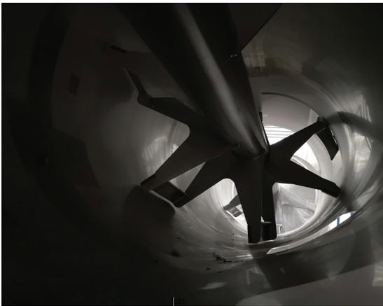
Dieser robuste, strapazierfähige Kühler nutzt die Umgebungsluft, um eine breite Palette von Mehlprodukten (in der Regel Mehl aus Geflügel, Fisch oder Fleisch) zu kühlen, nachdem sie einen Trocknungs- oder Kochprozess durchlaufen haben. Durch Kühlung werden Presskuchen brüchiger und damit leichter zu Vermahlen.
