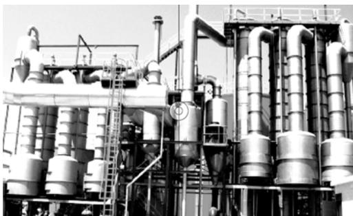
Le fonctionnement des évaporateurs Haarslev les plus couramment utilisés repose sur le principe du flot tombant pour concentrer ces liquides, en tirant l'énergie thermique du sécheur afin d'amener le liquide jusqu'à des températures auxquelles les particules d'eau s'évaporent. Vous pouvez donc obtenir des concentrations plus élevées à moindre coût, contenant des protéines supérieures dissous afin d'augmenter les rendements de votre configuration de production de farine.
