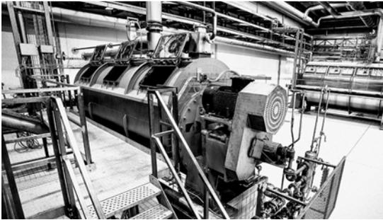
霍斯利连续盘管式干燥机适用于对可自由流动、半干、低脂的进料(包括鱼粉、血液和羽毛)进行连续干燥。
