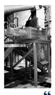
在将经过蒸煮的动物副产品传送用于干式炼脂工艺中的油脂分离步骤之前,确保其颗粒尺寸的均匀一致。
