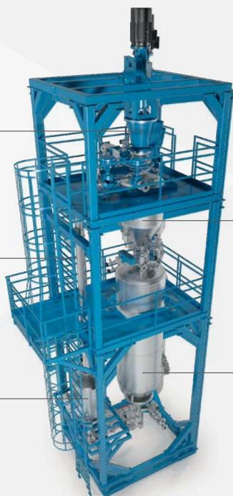
Подача сырья из находящейся под давлением емкости в емкость испарения только за счет клапанов и перепада давления без необходимости использования смесителя.
