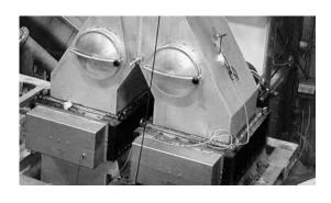
适用于缩小所有肉类和家禽 副产品的颗粒尺寸,或用于打 散羽毛。 更小、更一致的颗粒大小是提高各种肉 类和家禽加工装置效率的有效途径。 颗粒越小,加热过程的成本效益和能源 效率就越高,这使得霍斯利精细粉碎机 成为注重运营成本的加工生产线上的 一个重要补充。
