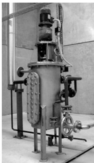
Это простое и надежное устройство, которое помогает повысить эффективность широкого спектра процессов обработки крови животных и птицы за счет коагуляции твердых компонентов, облегчающей удаление воды.
