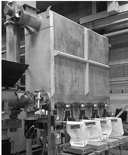
Una unidad de embolsado compacta de Haarslev que fue diseñada para manejar la homogenización y distribución en las bolsas con un peso uniforme y preciso. La unidad de embolsado compacta recibe la harina por medio de un tornillo transportador o transporte neumático. Mientras los tornillos hacen circular el producto por la tolva, se pueden llenar las bolsas con harina con los tornillos alimentadores de distribución.
